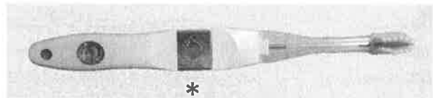
図 1 本研究で用いた電子歯ブラシ 3V のリチウム電池 (*) が内蔵されており、この金属板を握りながらブラッシングを行うと、体内に回路が形成され、微小電流が発生する。
